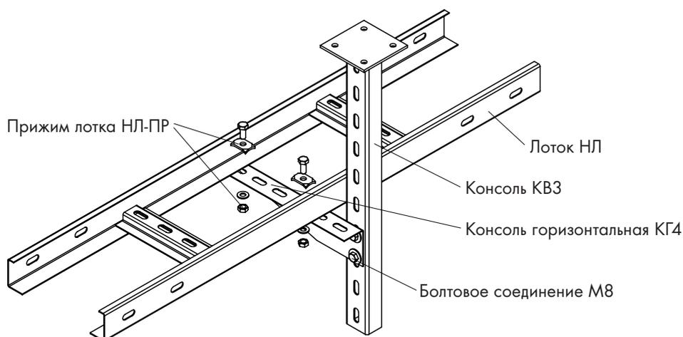
\*Применяется преимущественно для лестничных лотков, другие типы лотка фиксируются болтовым соединением M8 через перфорационные отверстия в днище лотка или просверленные при монтаже отверстия
