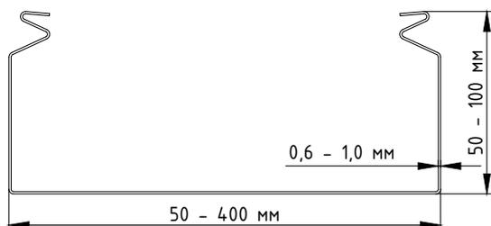
В данной серии возможно изготовление лотков нестандартных размеров с шириной до 1000 мм и высотой борта до 200 мм
