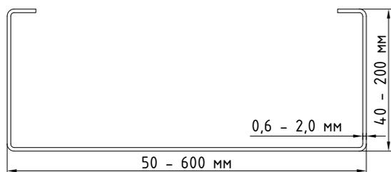
В данной серии возможно изготовление лотков нестандартных размеров с шириной до 1000 мм и высотой борта до 200 мм
