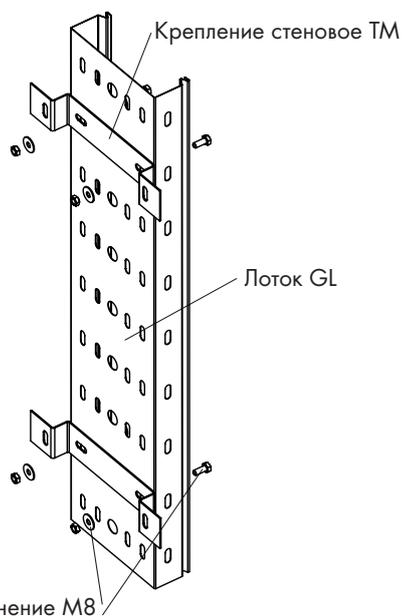
лотка при креплении на шпильки (см. монтаж с помощью шпилек). Крепление ТМ монтируется на поверхность с помощью болтового соединения М8
