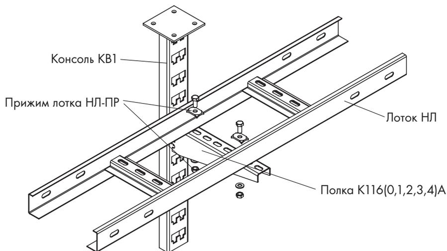
\*Применяется преимущественно для лестничных лотков, другие типы лотка фиксируются болтовым соединением М8 через перфорационные отверстия в днище лотка или просверленные при монтаже отверстия
