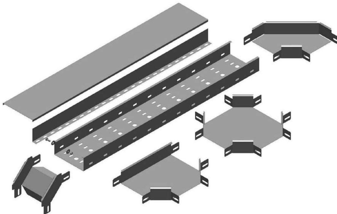
В стандартном исполнении изготавливаются из оцинкованной стали 0,6 – 2,0 мм (под заказ изготавливаются с другими типами покрытий). Представляют собой цельный профиль, изготовленный на листогибочном оборудовании. Имеют накладную крышку, которую необходимо при монтаже кабельной трассы крепить метизами к лотку.
