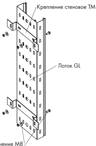
лотка при креплении на шпильки (см. монтаж с помощью шпилек). Крепление ТМ монтируется на поверхность с помощью болтового соединения М8
