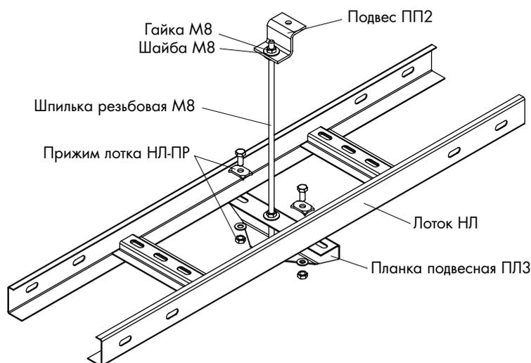
\*Применяется преимущественно для лестничных лотков, другие типы лотка фиксируются болтовым соединением М8 через перфорационные отверстия в днище лотка или просверленные при монтаже отверстия
