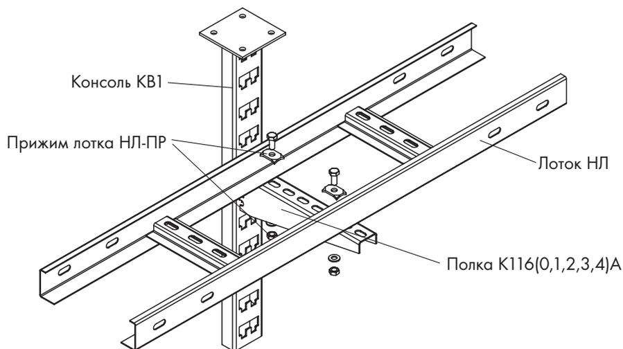
\*Применяется преимущественно для лестничных лотков, другие типы лотка фиксируются болтовым соединением M8 через перфорационные отверстия в днище лотка или просверленные при монтаже отверстия
