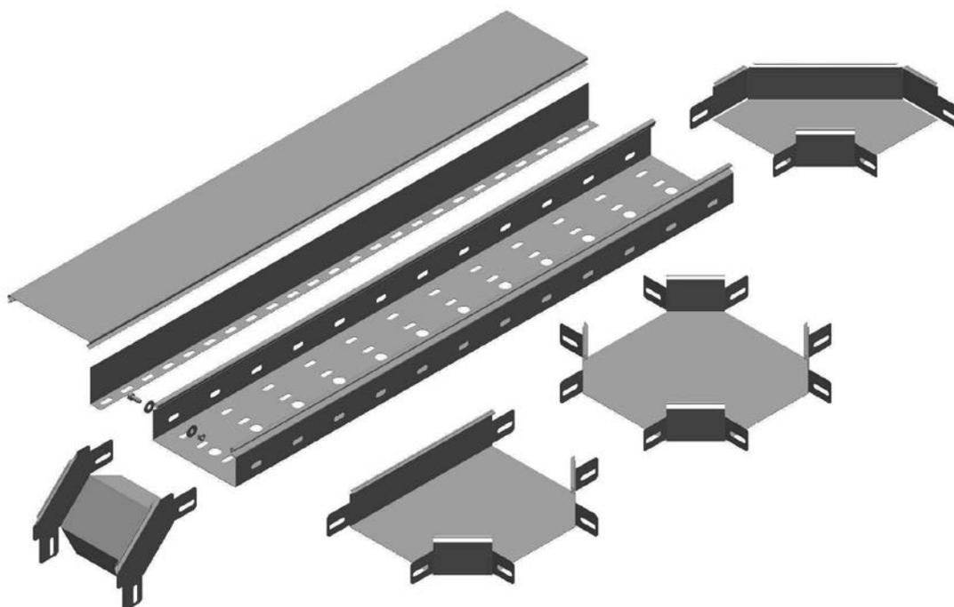
Лотки представляют собой цельный профиль, изготовленный на прокатной линии. Высокотехнологичное оборудование позволило внедрить инновационное решение по плавному профилю замка и жесткости конструкции. Замок лотка имеет дельтавидную форму и представляет собой плавный замкнутый профиль, что позволяет исключить острые кромки и обеспечить безопасность монтажа и сохранность кабеля. Кроме того, замок позволяет надежно фиксировать крышку и увеличивает жесткость лотка.
